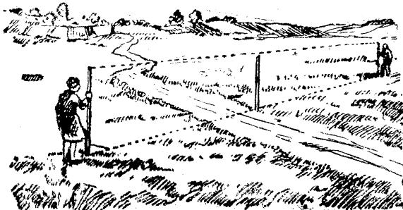
Вехи ставятся так, чтобы две из них закрывали третью. Измерение линий на поверхности земли производится рулеткой или металлической мерной цепью длиной в 20 м, или полевым циркулем.
