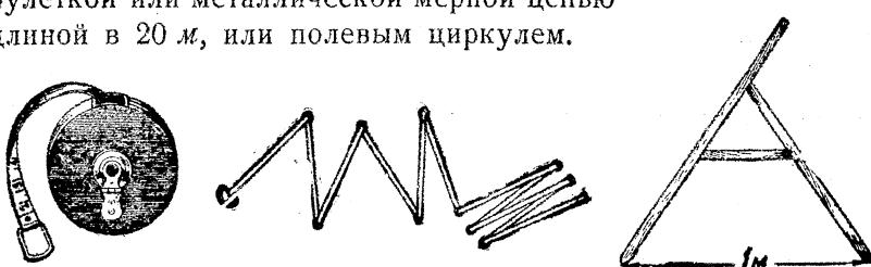
Вместо мерной цепи можно изготовить мерную верёвку длиной в 10 м из тонкой бечёвки или шпагата.
