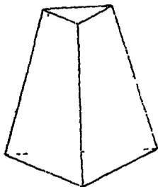
**637.** Нарисовать отдѣльно отъ «отсѣченной» части усѣченную пирамиду, начертить ея «сѣтку» и отдать себѣ отчетъ въ томъ, какъ вычислить боковую поверхность пирамиды, усѣченной параллельно основанію (Надо сначала вычислить площадь каждой трапеции)
