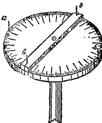
Рис. 34. Астролябия простейшего устройства.
