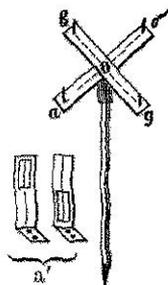
Снизу эккера, противъ точки пересѣченія линій, проведенныхъ на верхней поверхности линейекъ, укрѣпляется винтами цилиндрическая трубка, которою эккеръ надѣвается на палку, заостренную и окованную снизу желѣзомъ—для удобнаго втыканія въ землю.
