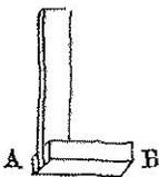
къ ровному краю доски, а по направленію другой линейки наугольника проводятъ карандашемъ линію; послѣ сего переключиваютъ наугольникъ на другую сторону, и если при этомъ линейка, по которой провели линію, будетъ совершенно прилегать къ ней (къ линіи), то прямой уголъ въ наугольникѣ
