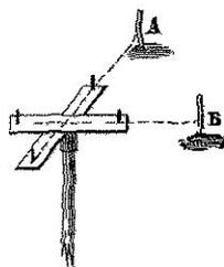
Чтобы повѣрить, перпендикулярно ли скрѣплены линейки эккера, его надѣваютъ на палку, которую отвѣсно втыкаютъ въ землю и по направленію обѣихъ паръ шпеньковъ ставятъ вѣшки *А* и *Б* (черт. 42); послѣ сего дѣлаютъ эккеромъ  $\frac{1}{4}$  оборота, т. е. поворачиваютъ его такъ, чтобы та пара шпеньковъ, которая была направлена на вѣху *А*, была бы направлена на вѣху *Б*,—если послѣ этого другая пара шпеньковъ покроетъ вѣху *А*, то эккеръ вѣренъ, т. е. линейки его скрѣплены перпендикулярно.
