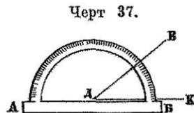
Чтобы построить угол известнаго числа градусо́въ помощью транспортира, нужно его приложить верхнимъ краемъ линейки АБ (черт. 37) къ линіи при которой строится уголъ, такъ, чтобы центръ транспортира находился надъ точкою, принятою за вершину угла, потомъ, отсчитавъ отъ  $0^{\circ}$  по дугѣ транспортира данное число градусо́въ, ставить противъ этого дѣленія на бумагѣ точку. Снявъ транспортиръ, соединяють эту точку съ точкою, принятою за вершину угла, получаютъ требуемый уголъ.
